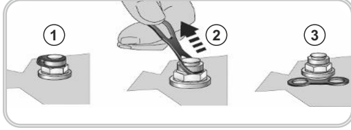
Şekil 3: Havalandırma Tapasının Devreye Sokulması
